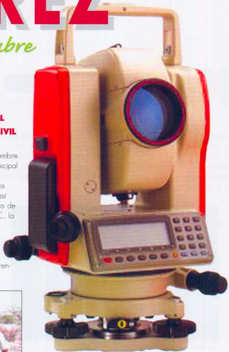
Estación total. Aparato de medición utilizado para trabajos de topografía.
